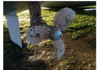
erreicht wird und die Klappfunktion der Klapppropeller erhalten bleibt. Nach fast 1 Stunde mühsamen Schabens sind die Muscheln und die Kalkschicht weitgehend entfernt. Die Propeller glänzen zwar nicht wie neu aber die Funktion dürfte wieder bei 100 % liegen.
