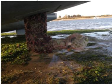
Bis NW (Niedrigwasser) um 19:10 Uhr ist noch eine Stunde Zeit, also hole ich schnell den großen Schraubenzieher und den kleinen Hammer und befreie den Propeller vom störenden Anhängsel. Erstaunlich, dass trotz des Bewuchses ein guter Vortrieb
